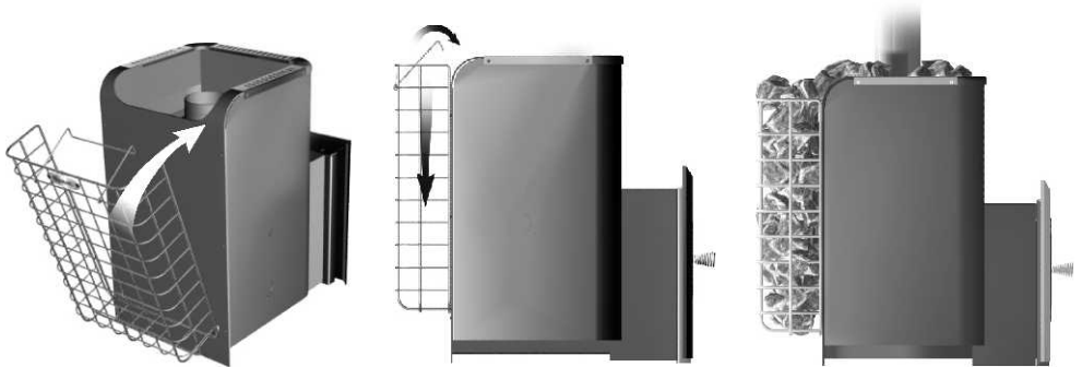
Рисунок - 10. Установка сетки-каменки на печь.
